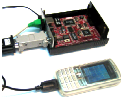
IntelMote2 (łączość ZigBee, sensory oświetlenia i temperatury)
